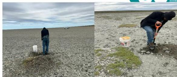
Figura 4. Las muestras fueron tomadas en tres lugares representativos, objeto de estudio los que corresponden a sustrato, posteriormente se juntan las submuestras o porciones y se mezclan en balde. De esta mezcla del balde se extrae una porción de más de 2 kilos para enviar a laboratorio.
